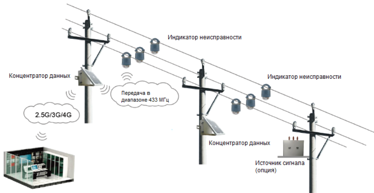
Система сигнализации с центральной станцией (SCADA)
